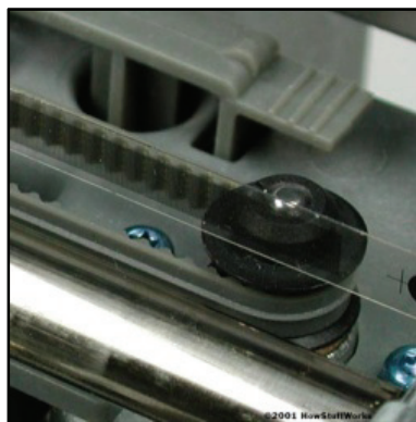
Figura 2.3: Belt carriage e encoder strip de uma impressora a jato de tinta [11]
